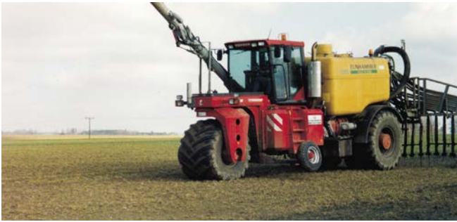
66. Zur großflächigen und bodennahen Ausbringung von Gülle hat eine Gemeinschaft von 40 Landwirten diese Spezialmaschine erworben. Sie bleibt während der Arbeit auf dem Acker, der Stoff wird per Tankwagen zugefahren.
