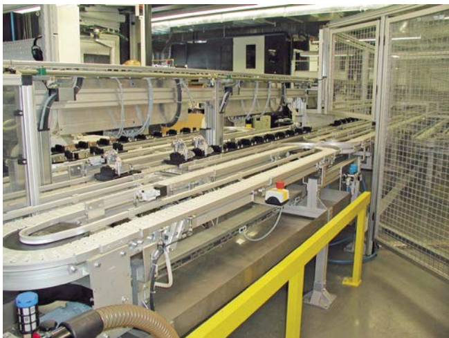
58. Bopfingen, Gesellschaft für Verkettungsanlagen, Automationseinrichtungen und Fördertechnik mbH. Transportsystem für Ölfilterhalter Audi
